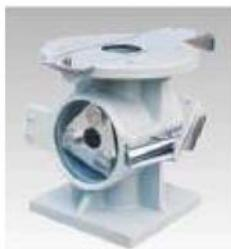
Корпус магнитной базы изготовлен из алюминия, укомплектован распашной дверцей со стеклянным просмотровым окном и стержневым магнитом MR3, может эффективно улавливать металлические включения (на фото MB-400 – стандартная конфигурация)
